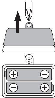
①おもちゃボード裏面の電池ケースのカバーのねじをプラスドライバーでゆるめて開けます。
