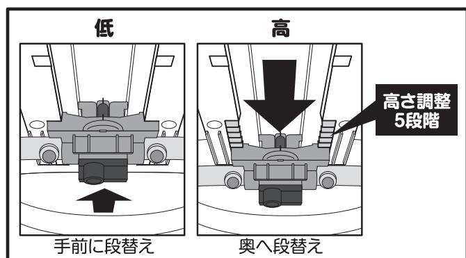
片手で高さ調節ストッパーの手前側に押しながら、もう一方の手でテーブルを持ち、高さ調節を行ってください。
