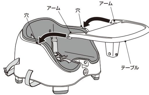
② テーブル下のサポート支柱を椅子の股部分の凹部分へ、カチッと音がするまで挿入する。
