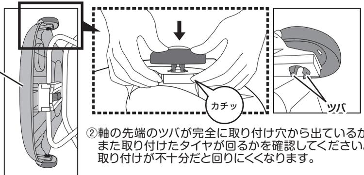
②軸の先端のツバが完全に取り付け穴から出ているか、また取り付けしたタイヤが回るかを確認してください。取り付けが不十分だと回りにくくなります。
