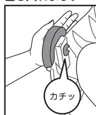
ツバが取り付け穴を通り抜けるとカチッと音がします。
