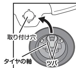
軸の先端は脱落防止のツバになっています。
