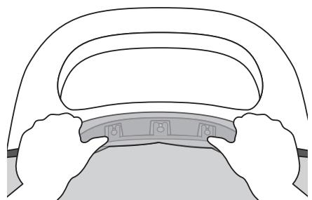
留め具(b)の凸部分をウォーカー本体側の穴に入れて(①)、押し下げて(②)、固定してください。
