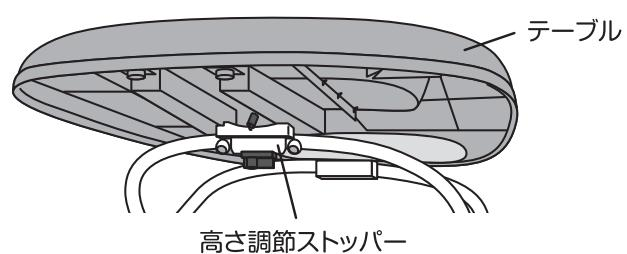
片手で高さ調節ストッパーの手前側に押しながら、もう一方の手でテーブルを持ち、高さ調節を行ってください。
