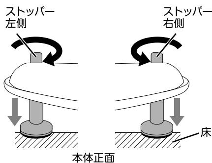
ストッパーを下に押しながら、止まるまで矢印の方向にひねってください。その後、ストッパーが床に設置し、本体が動かないことを確認してください。
