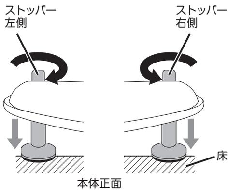
ストッパーを下に押しながら、止まるまで矢印の方向にひねってください。その後、ストッパーが床に設置し、本体が動かないことを確認してください。
