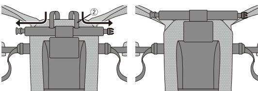
②ヘッドサポートが装着されていない場合には、ベビー肩ベルトをベビー肩ベルトカバーの左右のスリットから挿入してください。
