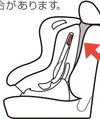
●受け側のバックルベルトが長いため、車両のバックルやタングが本装置とあたって、シートベルトが緩みしっかり締め付けができない座席。
