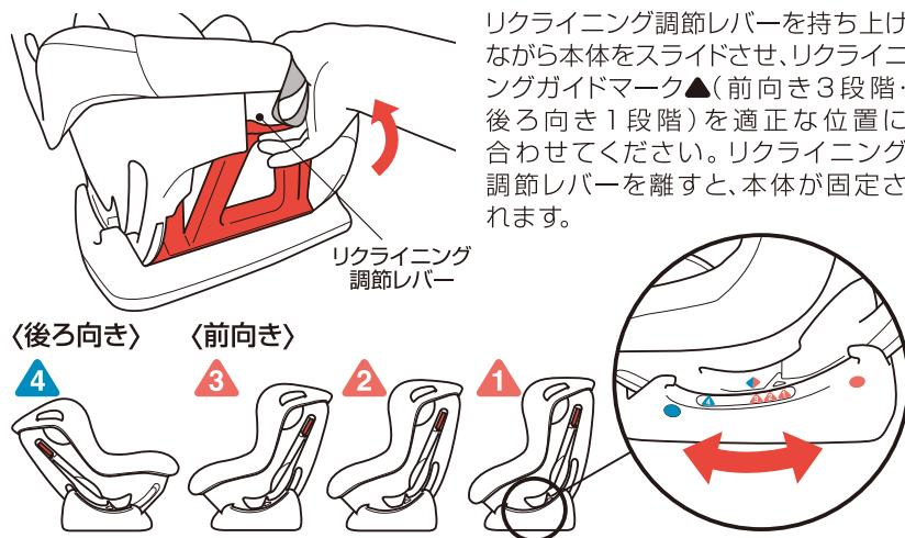
リクライニング調節レバーを持ち上げながら本体をスライドさせ、リクライニングガイドマーク▲(前向き3段階・後ろ向き1段階)を適正な位置に合わせてください。リクライニング調節レバーを離すと、本体が固定されます。
