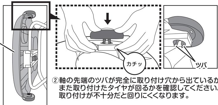
②軸の先端のツバが完全に取り付け穴から出ているか、
