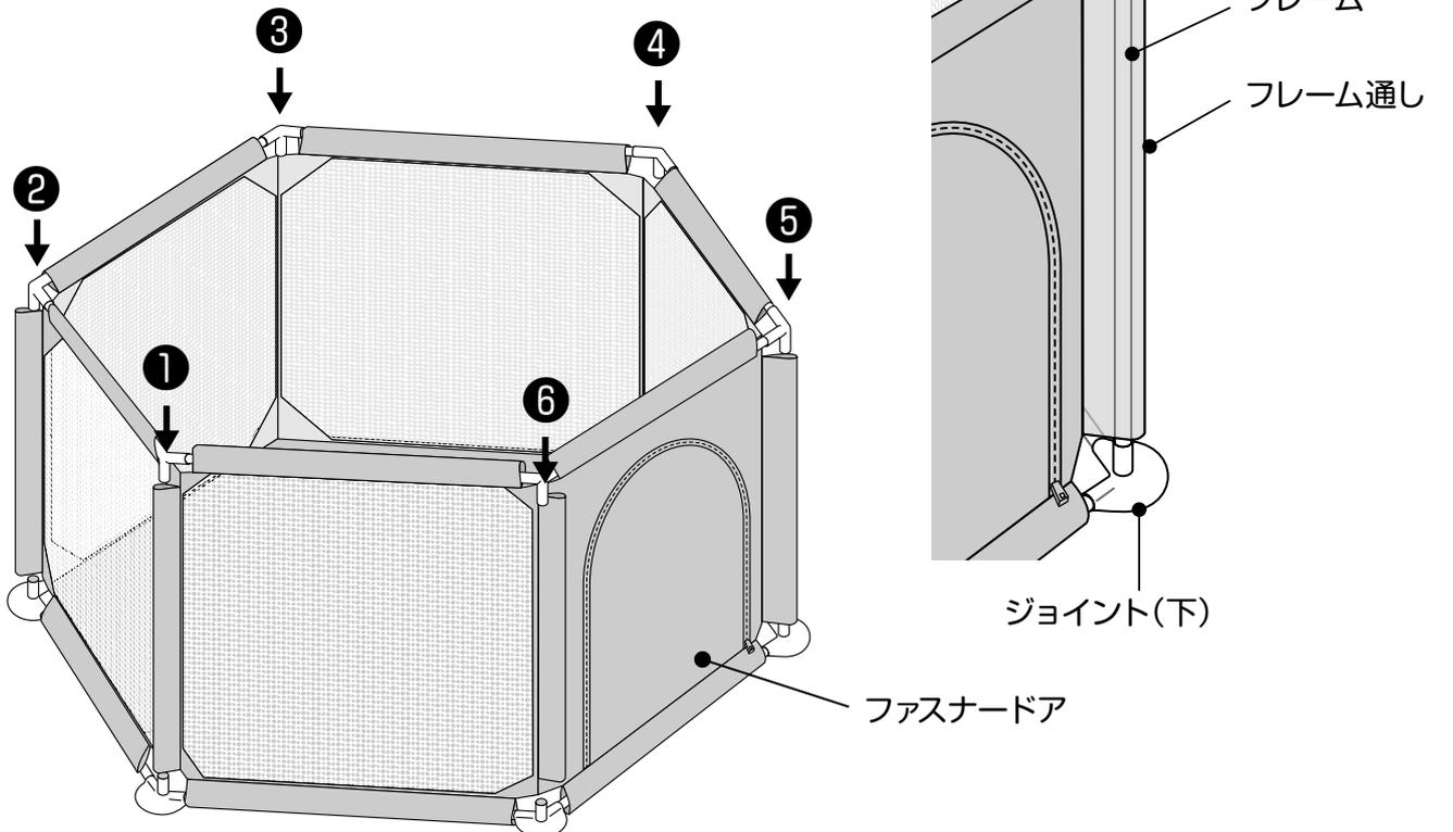
ネットの張りを確保するために、最後のフレームの組み付けは非常に固くなっています。
