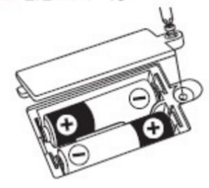
電池ボックスは本体の裏側にあります。プラスドライバーでネジを外し、電池カバーを開けて、図のように電極+-を確認し入れてください。
