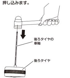
事軸を本体の取り付け穴に通します。残っている 後ろタイヤを車軸に取り付け、ハンマーで静かに たたいて押し込みます。
