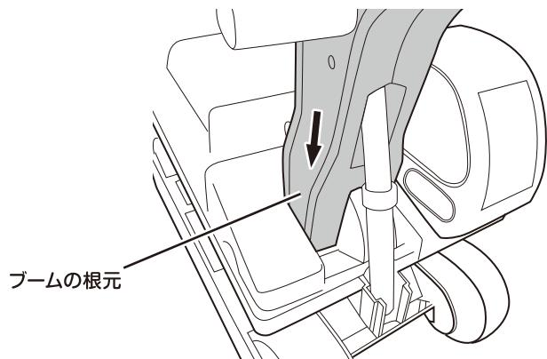
**4** ブーム軸を本体の軸穴に差し込みます。
