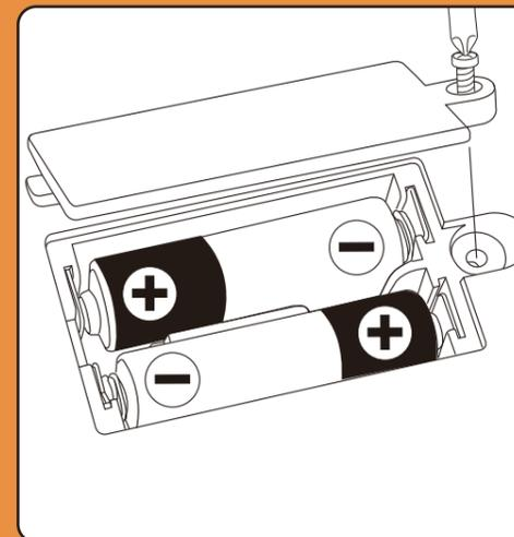
※電池の入れ方：プラスドライバーで電池カバーを取外し、図のように電極+を確認し入れてください。
